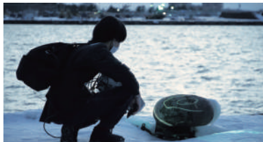
卒業作品となった4つ目の移動式投影機は土崎港にて投影。体の前方にプロジェクターとメディアプレーヤーを抱え、背中のリュックにはポータブル電源を。投影する位置を自分の体の向きで変えられます。背負う重さも分担でき、辿り着いたベストな形。
